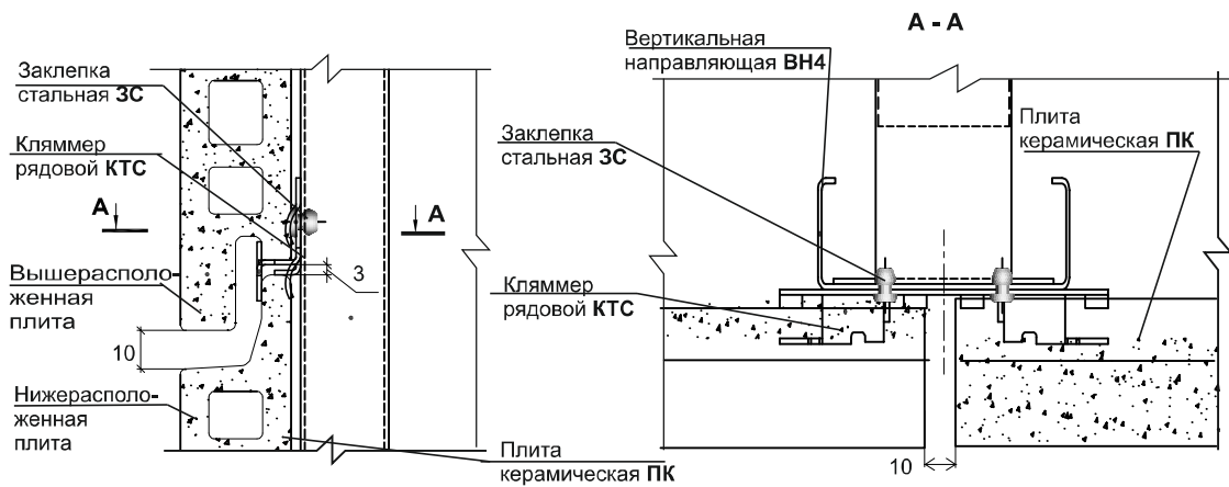
Рисунок 76. Схема установки плиты керамической ПК на кляммеры КТС
