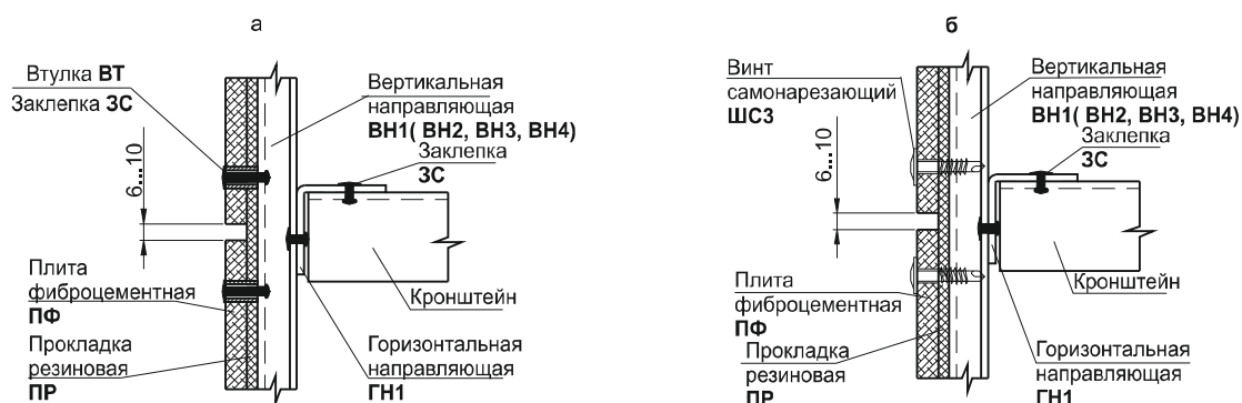
Рисунок 39. Узел горизонтального открытого шва крепления плит.
